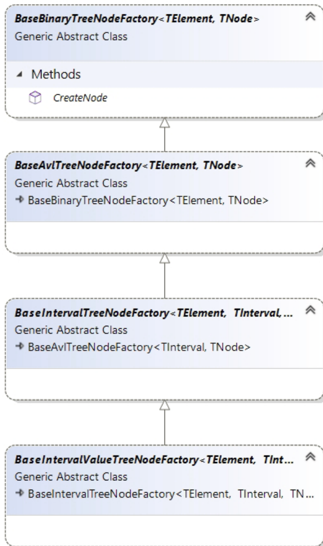
Рисунок 8 – Иерархия базовых классов абстрактных фабрик узлов бинарных деревьев поиска
